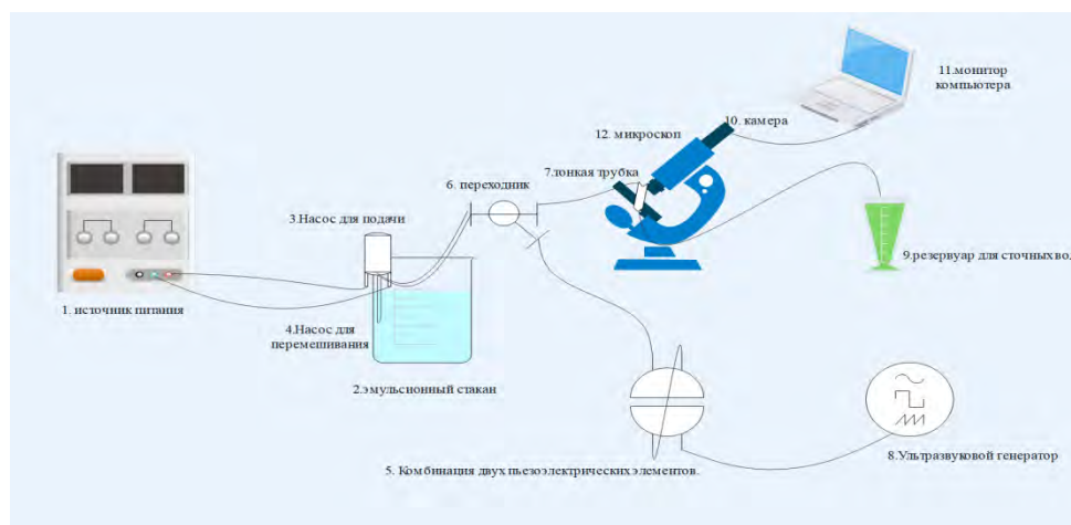
Рис. 1. Схема эксперимента по ультразвуковой деэмульсации
