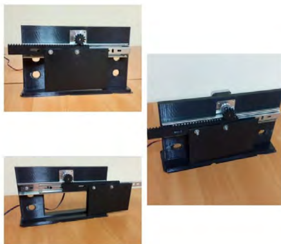
Рис. 3. Собранный прототип управляемого преграждающего устройства
