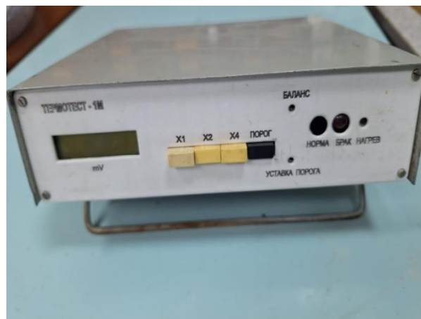
Рисунок 18 – Дифференциальный датчик, а – схематичное изображение датчика, б – фотография электронного блока
