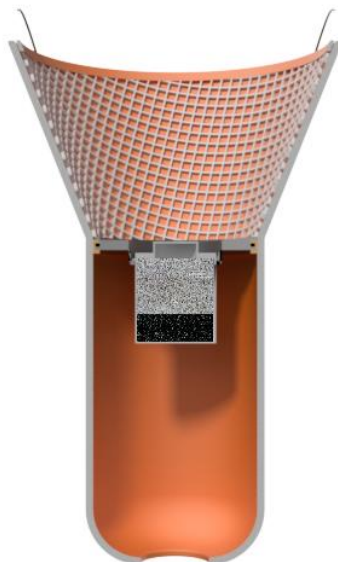
Рис. 5. Блок забора мусора в разрезе
