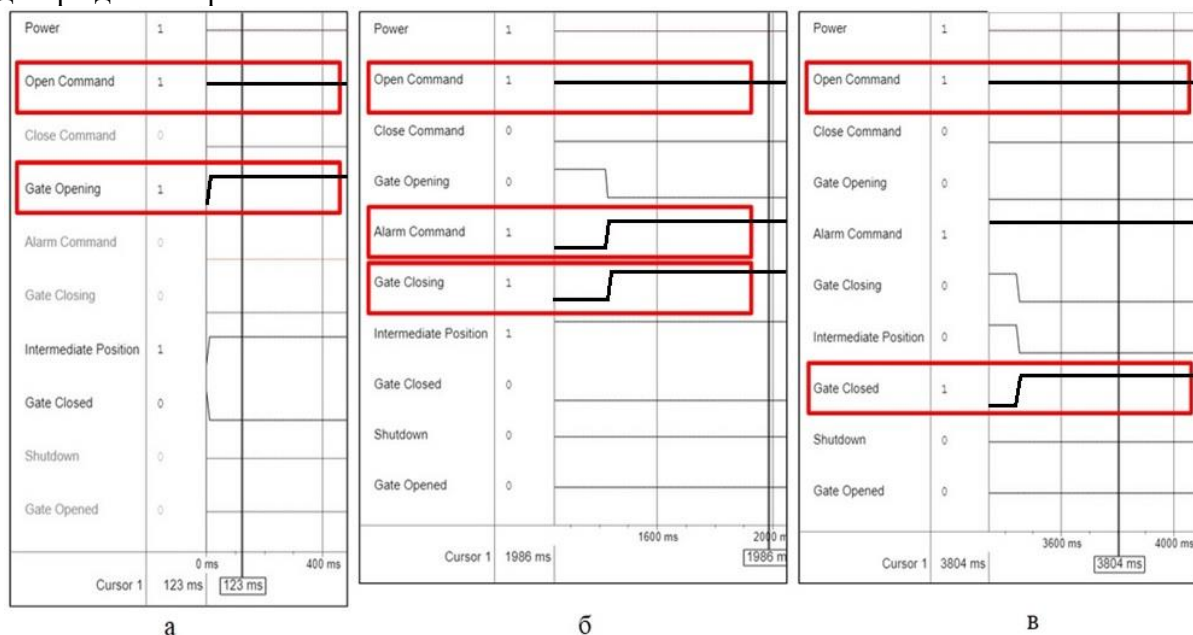
Рис. 3. Входные и выходные сигналы модели в случае обработки сценария появления команды «Пожар»:
