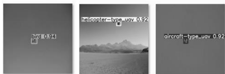
Рис. 3. Пример детектированных объектов на изображениях из тестового набора датасета с объектами малых размеров
