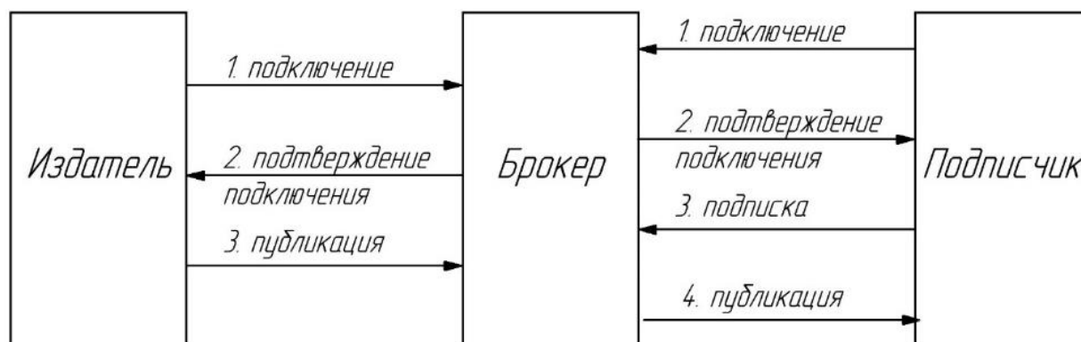
Рис. 1. Схема коммуникации по MQTT-протоколу
