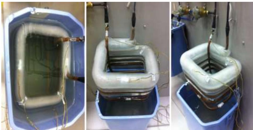
Рисунок 6.10 – Обмерзание испарителя
