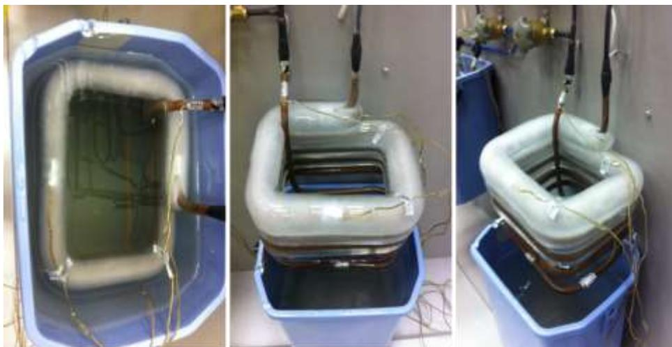
Рисунок 6.10 – Обмерзание испарителя
