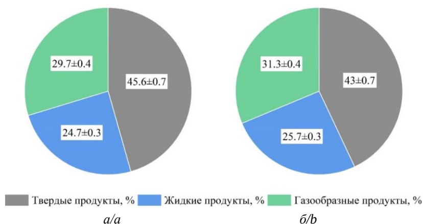
Рис. 5. Материальный баланс пиролиза куриного помета с добавлением опилок в соотношении 80/20 %: а) слоевая засыпка; б) смешивание компонентов Fig. 5. Material balance of chicken litter pyrolysis with sawdust addition in the ratio of 80/20%: а) layer filling; б) mixing of components
