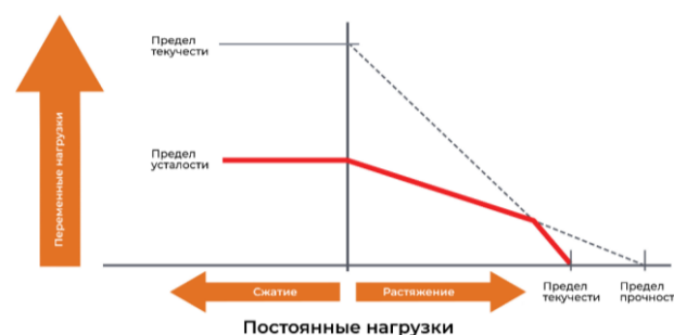
Рис. 3. Предел выносливости [26] Fig. 3. Fatigue strength [26]
