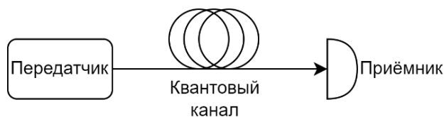
Рис. 1. Структурная схема системы КРК, состоящая из передатчика, квантового канала и приёмника
