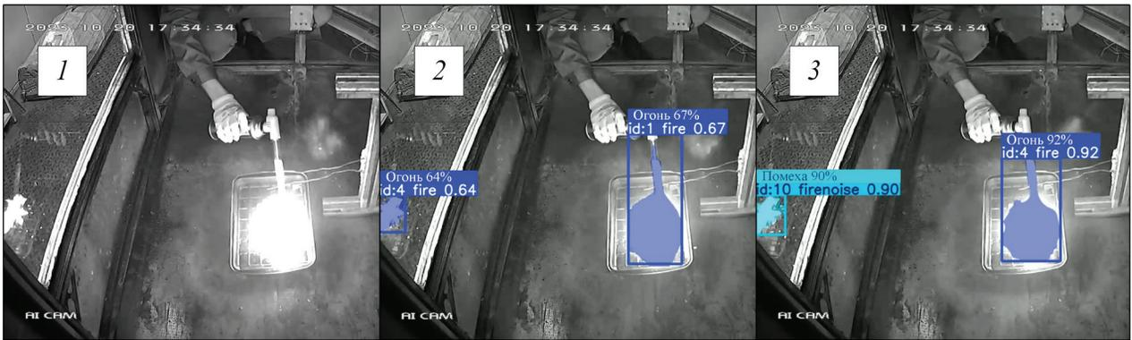
**Рис. 3.** Результат применения модели идентификации пламени при наличии помех: 1 — обрабатываемое изображение; 2 — модель при разметке только пламени (fire); 3 — модель при разметке класса пламени (fire) и класса помех (firenoise)
