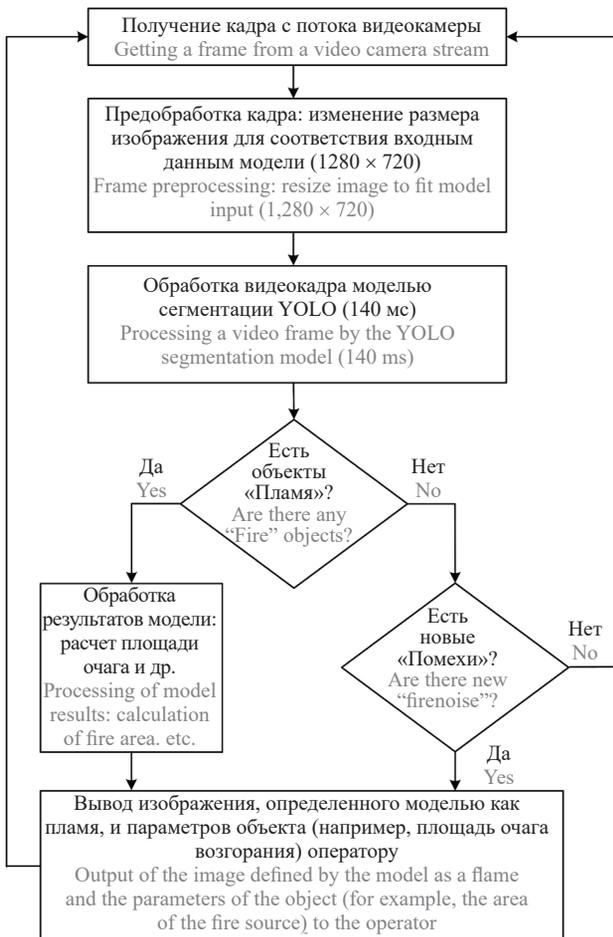
**Рис. 4.** Алгоритм применения модели идентификации очага возгорания в системе пожарной безопасности с использованием видеокamеры
