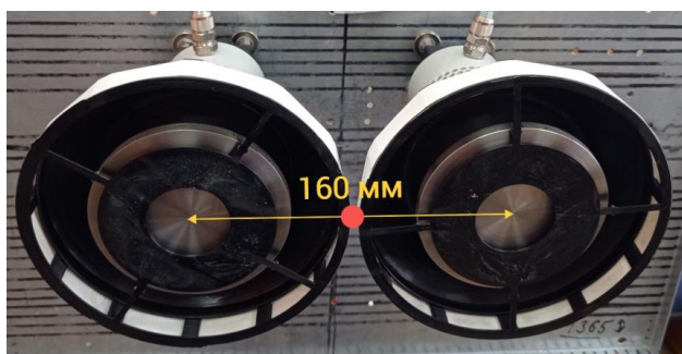
Рис. 11. Два ультразвуковых излучателя с отражателями и экранами Fig. 11. Two ultrasonic emitters with reflectors and screens
