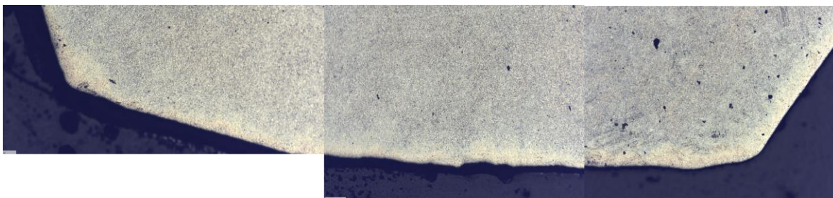
Рис. 3. Твердосплавное вооружение шарошечного долота 215 ОК-ПВ после криогенной обработки
