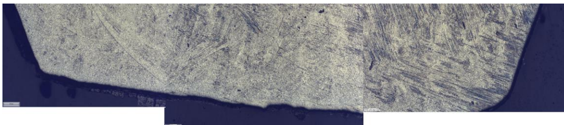
Рис. 2. Твердосплавное вооружение шарошечного долота 215 ОК-ПВ до криогенной обработки
