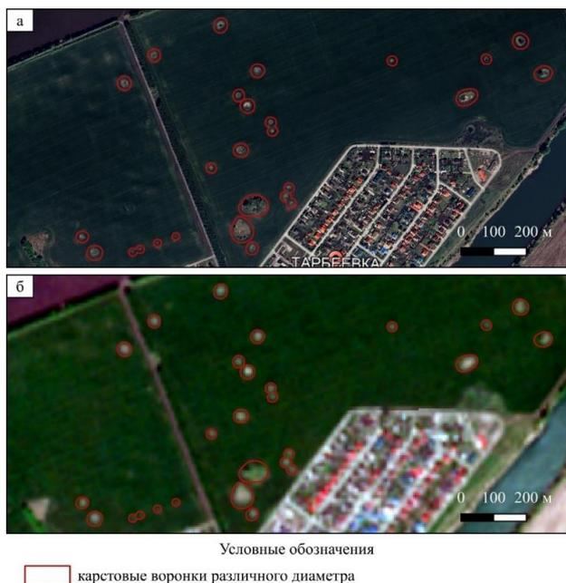
**Рис. 1.** Поле карстовых понижений около г. Уфы: а) снимок высокого разрешения Google (Maxar, май 2023 г.); б) снимок с спутника Sentinel-2A (18 мая 2023 г.)
