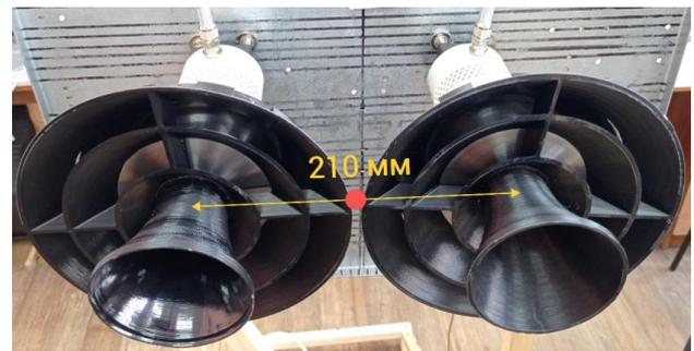
**Рис. 13.** Два ультразвуковых излучателя с отражателями и рупорами
