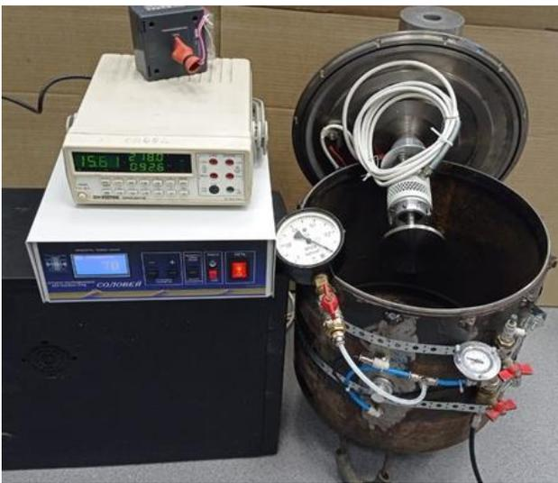
Рис. 5. Стенд для измерения акустической мощности
