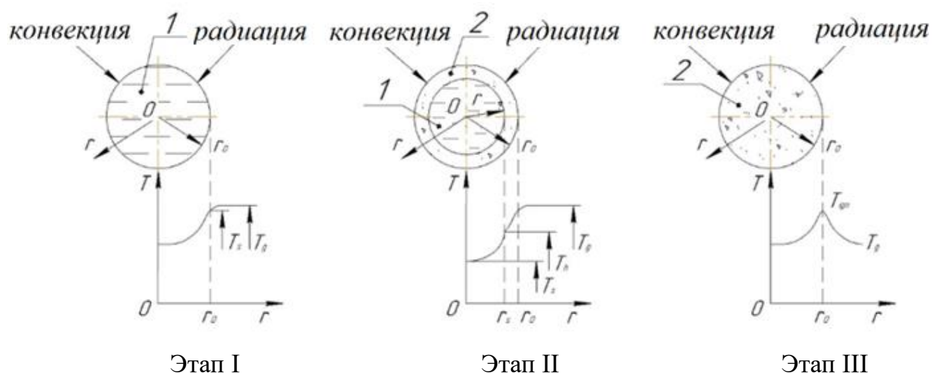
Рисунок 4.4 – Область решения задачи зажигания капли ВУТ
