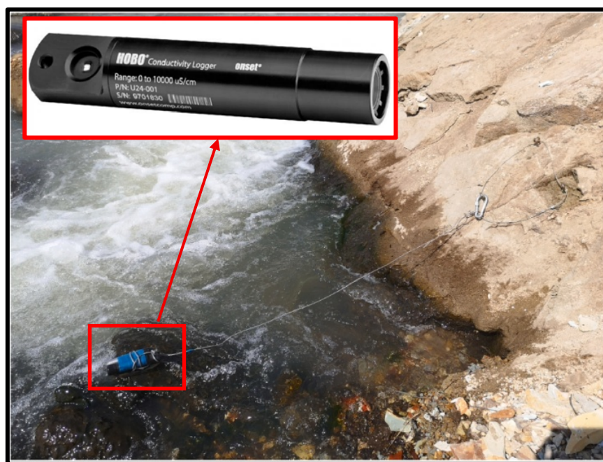
Рисунок 3.2 – Регистратор удельной электропроводности фирмы НОВО U24-001 перед установкой в р. Гейзерная
