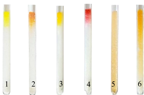
1 – ХЖ; 2 – ЖСЗ; 3 – ТАР; 4 – Кармин; 5 – β-каротин; 6 – Куркумин C_{ХЖ, ЖСЗ, ТАР, Кармин} = 1 мг/л, C_{\beta\text{-каротин}} = 5 мг/л, C_{\text{Куркумин}} = 50 мг/л, pH\ 1,0 , V_{p\text{-ра}} = 10 мл, v_{\text{потока}} = 1 мл/мин Рисунок 14 – Фотографии миниколонок, заполненных SC-ПГМГ, после концентрирования синтетических и натуральных красителей
