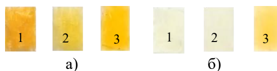
Рисунок 12 – SF-ПДДА после сорбции натуральных и синтетического красителей (а) и после десорбции водно-этанольными растворами (б)
