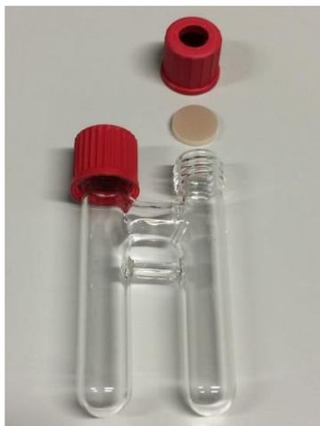
Рисунок 3 — Двухкамерный реактор
