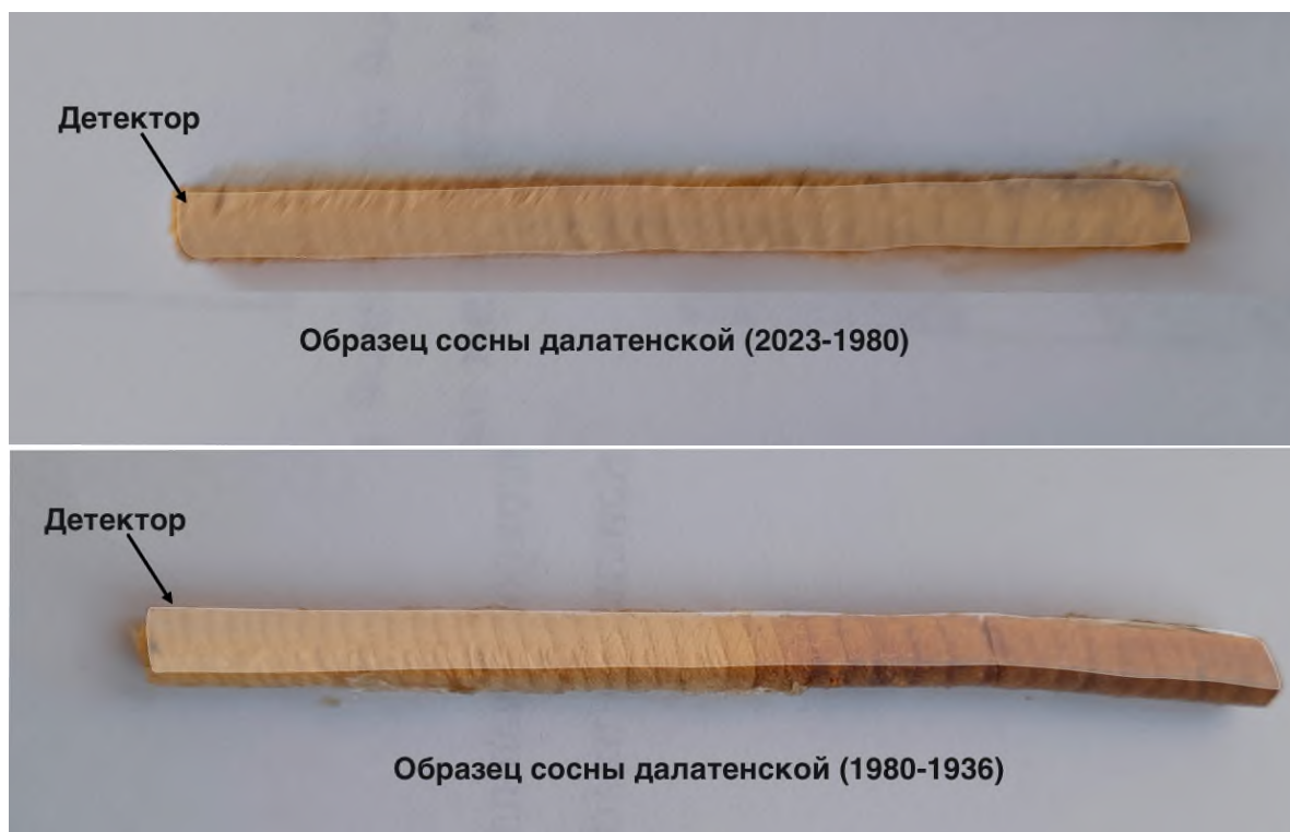
Рисунок 2.3.5.2 – Подготовка образцов древесины для проведения радиографических исследований
