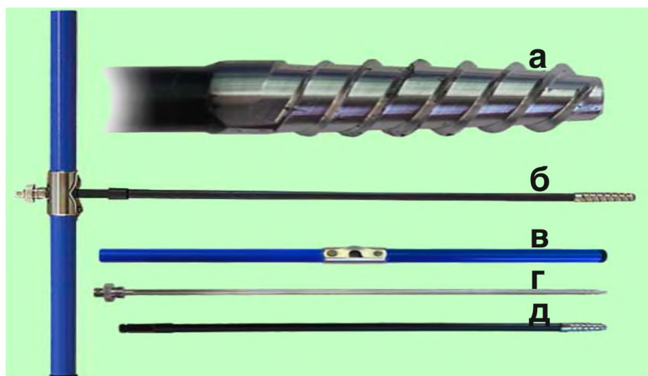
Рисунок 2.2.3 – Возрастной бурав. Условные обозначения: а – наконечник сверла; б – собранный бурав; в – стержень; г – экстрактор; д – сверло
