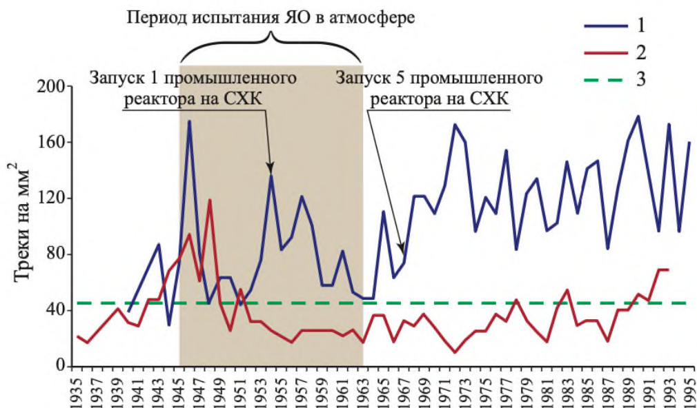
Рисунок 1.5 – Плотность треков от осколков деления U^{235} и трансурановых элементов в срезах деревьев Томской области, отобранных на разных удалениях от промышленного реактора: 1 – наблюдаемая кривая (5 км от реактора); 2 – наблюдаемая кривая (15 км от реактора); 3 – средний фон для Томского района [3]
