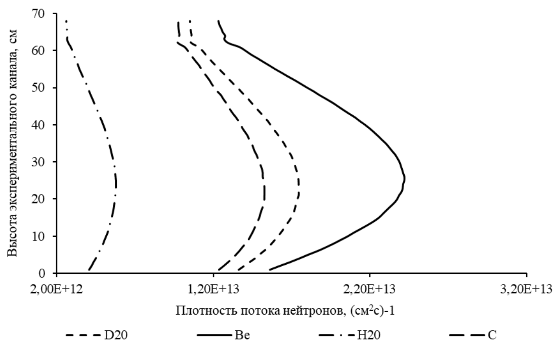
Рисунок 22 - Распределение плотности потока нейтронов по высоте нового экспериментального канала с призмами из разных материалов
