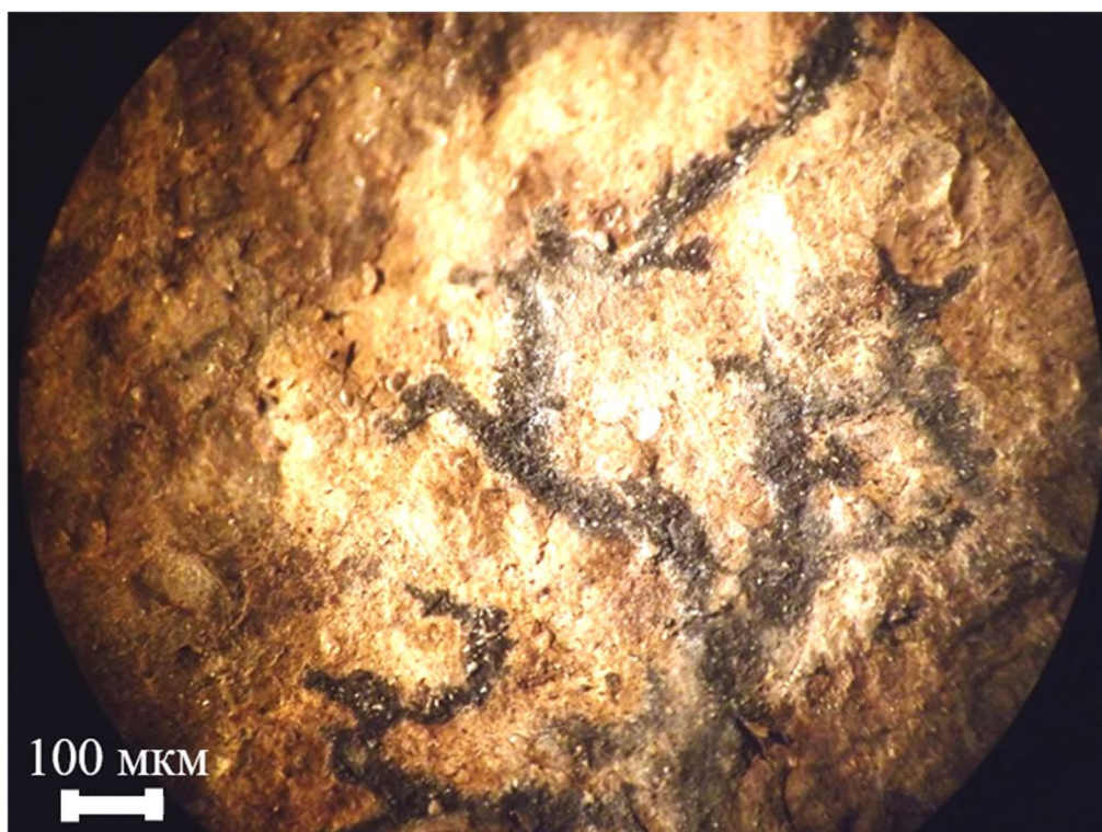
Рисунок 24 – Фотография дендрита через оптический микроскоп. Напряжения пробоя образца 2,2 кВ, межэлектродное расстояние 68 мм.
