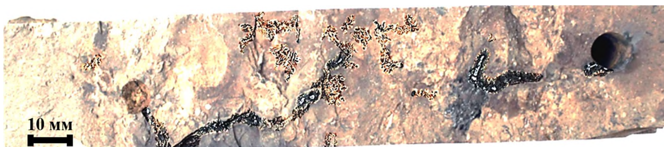
Рисунок 23 – Фотография образца, расщеплённого вдоль слоёв после пробоя (а), тоже с увеличенной резкостью в области канала пробоя и дендритов (б). Выдержка при 2,5 кВ 100 мин, с дальнейшим увеличением напряжения до пробоя – 3 кВ.
