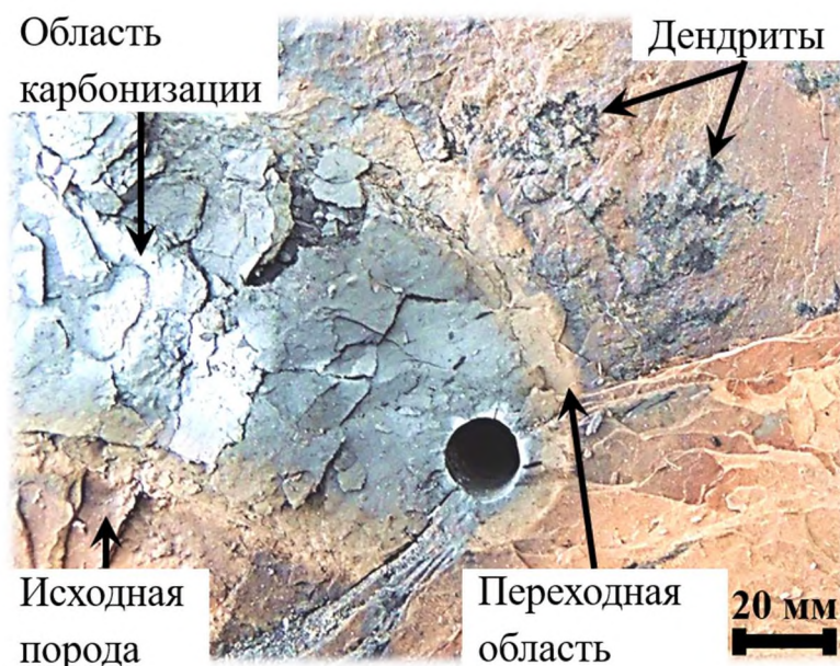
Рисунок 25 – Фотография образца горючих сланцев, подвергнувшегося частичной конверсии.
