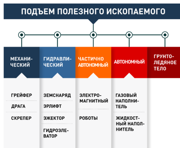
Рис. 2. Систематизация средств подводной добычи по принципу подъема полезного ископаемого
