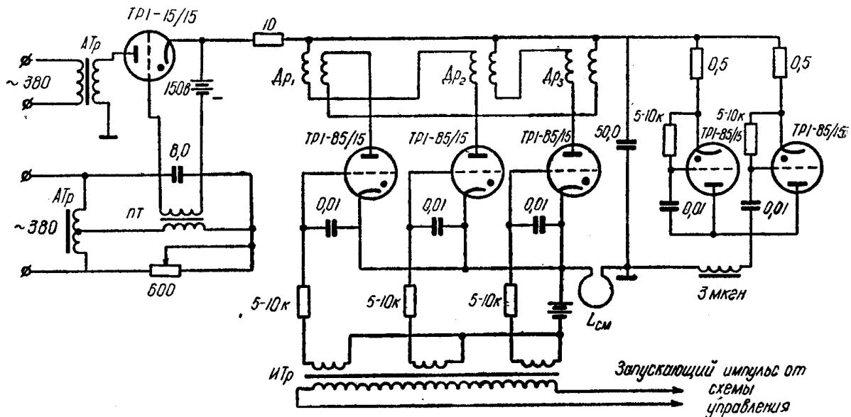
Рис. 2. Схема генератора, питающего расширительную обмотку
