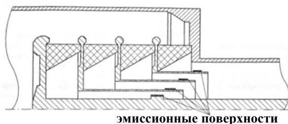
Рисунок 16 – Распределение напряжения с помощью эмиссионных поверхностей
