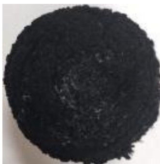
Рисунок 49 – Внешний вид планарного катода из углеродного волокна
