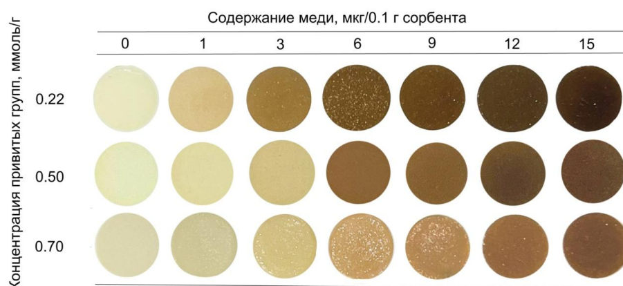
Рисунок 52 – Фотографии тест-шкал для определения меди с использованием silica gel 60 с различной поверхностной концентрацией привитых меркаптопропильных групп
