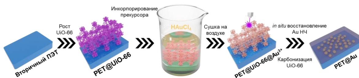
Рисунок 14. Схема метода лазер-опосредованного восстановления Au НЧ на поверхности PET@UiO-66
