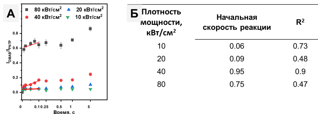
Рисунок 2.7 – Реакция азосочетания при плотностях мощности 0, 10, 20, 40, 80 кВт/см². А) Кинетические кривые; Б) Начальные скорости реакции.
