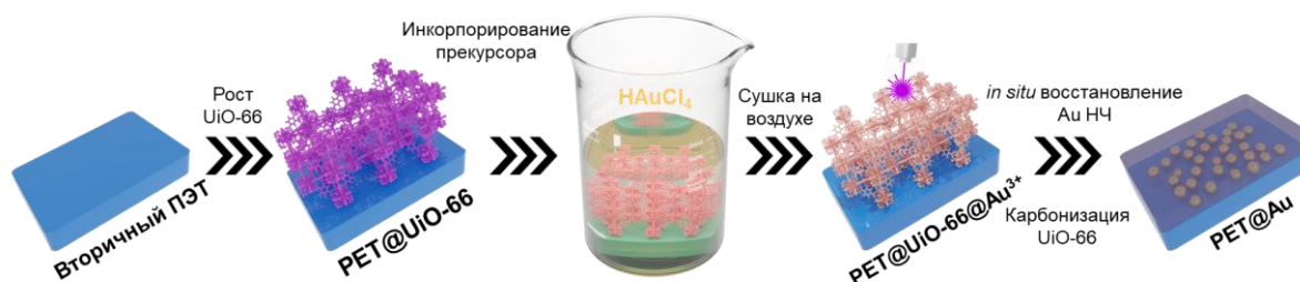
Рисунок 3.8 – Предлагаемая схема метода лазер-опосредованного восстановления Au НЧ на поверхности PET@UiO-66
