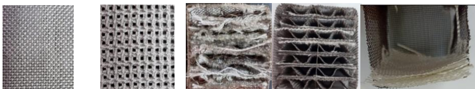
Рисунок 2 – Внешний вид Pt/CBK (плетение ткани: сатин и ажур) и блоков с объёмной сеткой и гофрированной и плоской металлической сеткой и многослойной укладки.
