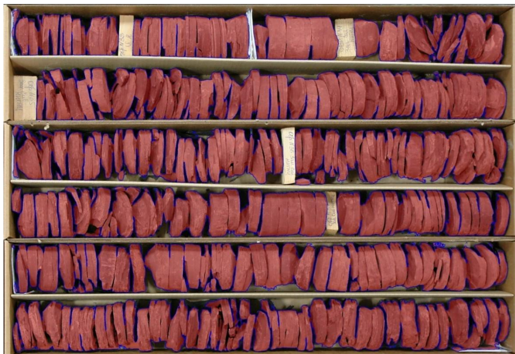
Рисунок 2.7 – Пример работы разработанной гибридной сети (синим выделены контуры, красным – сами образцы пород)
