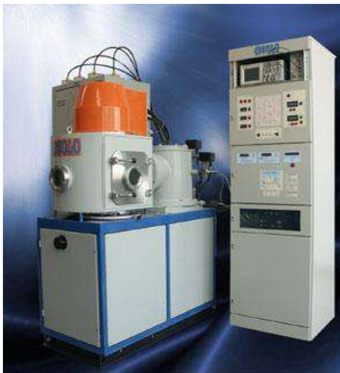
Рисунок 2.3 – Вакуумная импульсная электронно-пучковая установка «СОЛО»
