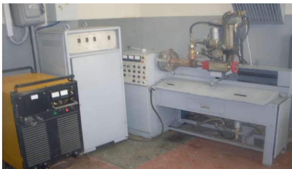
Рисунок 2.2 – Общий вид установки плазменной наплавки порошковыми проволоками УД-417
