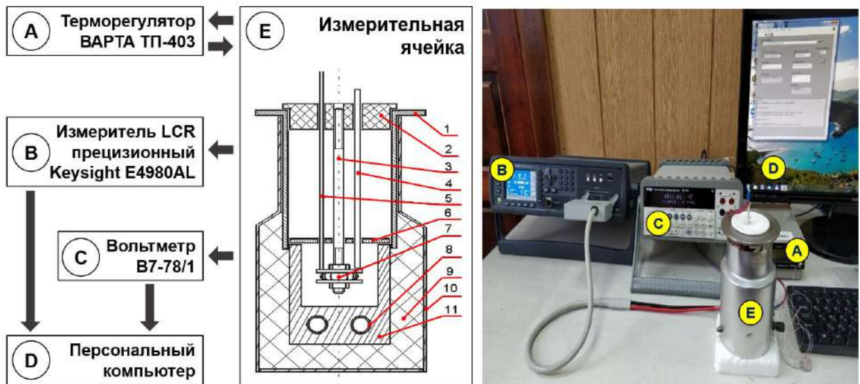
Рисунок 2.9 – Блок-схема и внешний вид экспериментального стенда для исследования температурной зависимости начальной магнитной проницаемости
