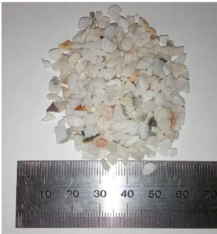
Рисунок 4а – Зерна электрокорунда ГОСТ 28818-90 со средним размером 4 мм
