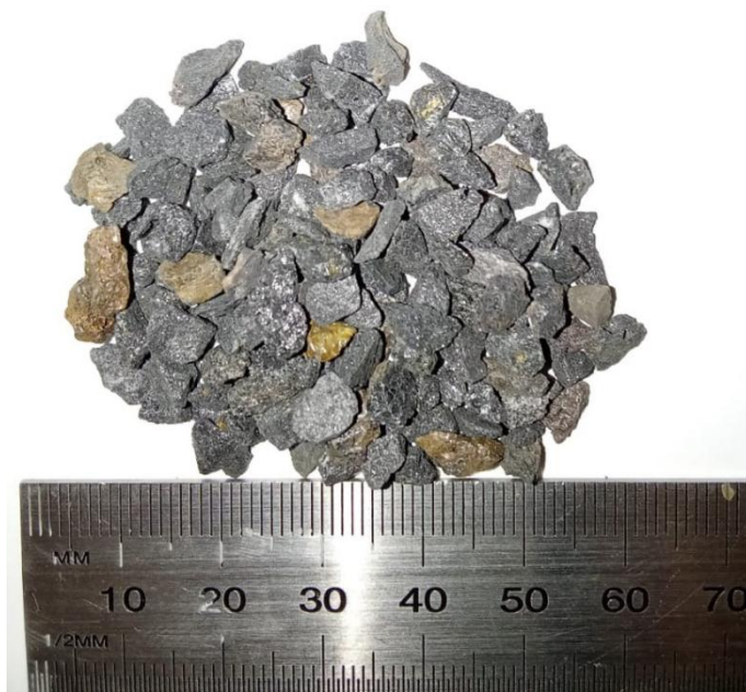
Рисунок 4б – Зерна электрокорунда ГОСТ 28818-90 со средним размером 5 мм
