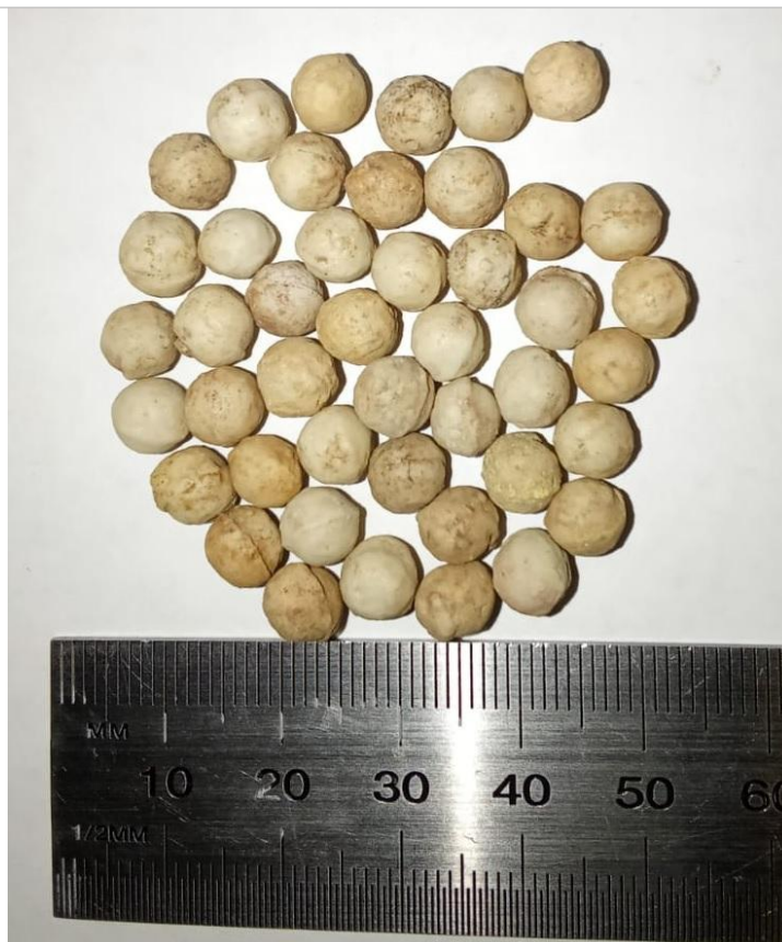
Рисунок 4в – Керамические шарики ГОСТ 20419-83 со средним диаметром 6,2 мм
