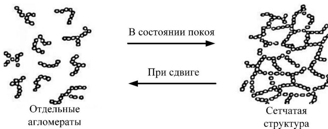
Рисунок 2.3.3 – Структура гелеобразного горючего в состоянии покоя и при сдвиге
