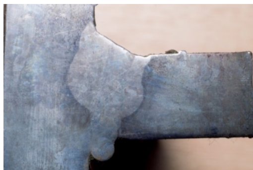
Рис. 2. Шлиф корневого шва таврового соединения толщиной 12 мм
