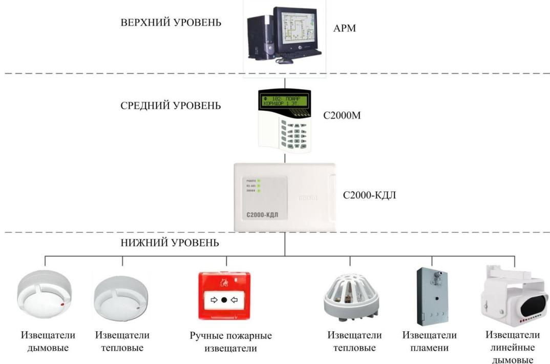
Рис. 1. Структурная схема адресно-аналоговой системы пожарной сигнализации
