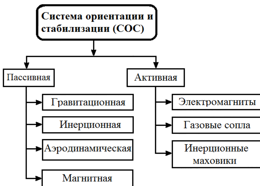
Рис. 1. Классификация систем ориентации КА
