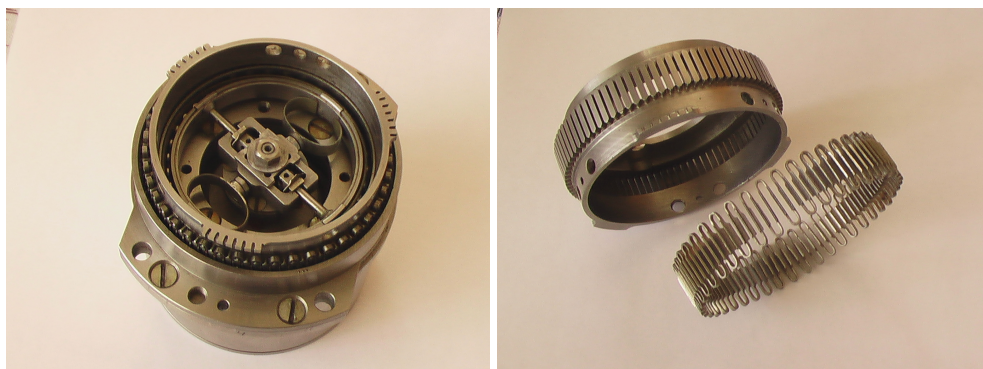
Рис. 2. Волновая передача со змеевидной пружиной (слева в сборе, – справа змеевидная пружина и обойма с пазами)
