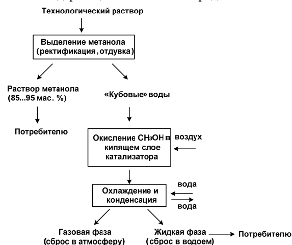
Рис. 8. Принципиальная схема утилизации и очистки производственных вод ГКМ от метанола
