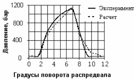
Рис. 3. Характеристики давления впрыскивания
