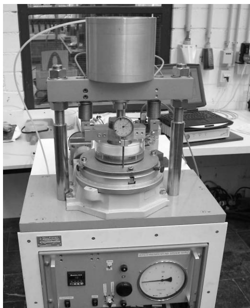
Рис. 1. Прибор кольцевого среза: 1) образец грунта; 2) дренажные кольца; 3) нижнее боковое кольцо; 4) верхнее боковое кольцо, имеющее возможность свободно вращаться по 3 и 6; 5) нижний рифленый штамп; 6) верхний рифленый штамп для приложения вертикальной нагрузки; 7) нижняя тарелка для передачи крутящего момента; 8) верхняя тарелка служит для передачи вертикальной нагрузки N перпендикулярно плоскости среза, жестко закрепленная для предотвращения вращения верхней обоймы и опрокидывания; 9) плоскость среза; 10) механизм кручения нижней тарелки вокруг вертикальной оси, крутящий момент M_T ; 11) емкость для увлажнения образца; 12) дренажные отверстия
