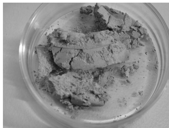
Рис. 6. Образец грунта после сдвига и высушивания
