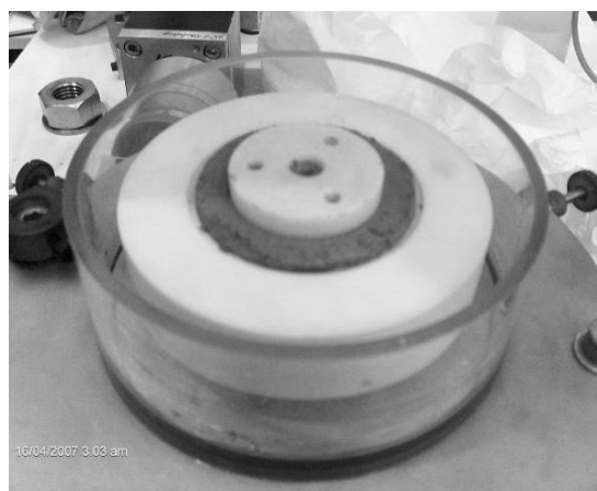
Рис. 5. Установка образца грунта в приборе кольцевого сдвига
