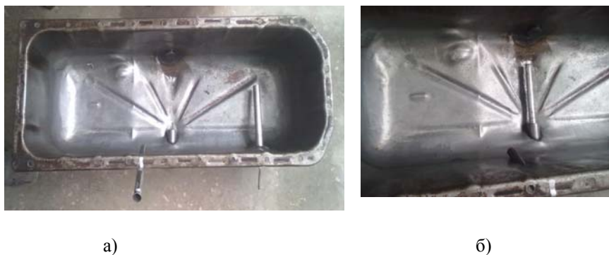
Рис. 2. Схемы установки электронагревателя в масляном картере двигателя СМД-14: а – нагревательное устройство установлено сбоку от сливной пробки; б - нагревательное устройство установлено непосредственно в сливное отверстие масляного картера
