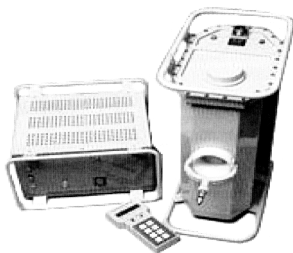
Рис. 13. Рентгеновский аппарат РАП 160-5
