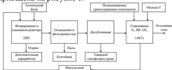
Рис. 1. Структурная схема действующего ПГУ
