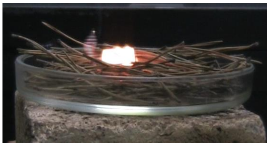
Рис. 2. Характерные кадры видеосъемки процесса зажигания ЛГМ нагретой до высоких температур частицей в различные моменты времени: t=0,20 с – появление пламени (зажигание ЛГМ).
