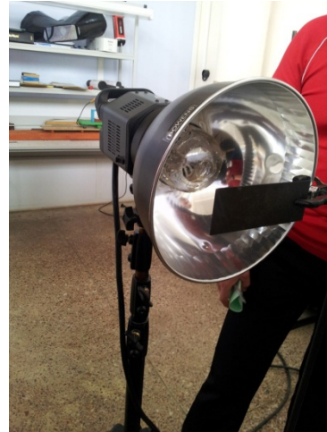
Рис. 2. Лабораторная установка, использующая ксеноновые импульсные лампы
