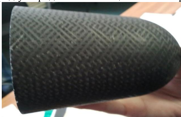
Рис. 2. Наконечник из углерод – углеродного материала
