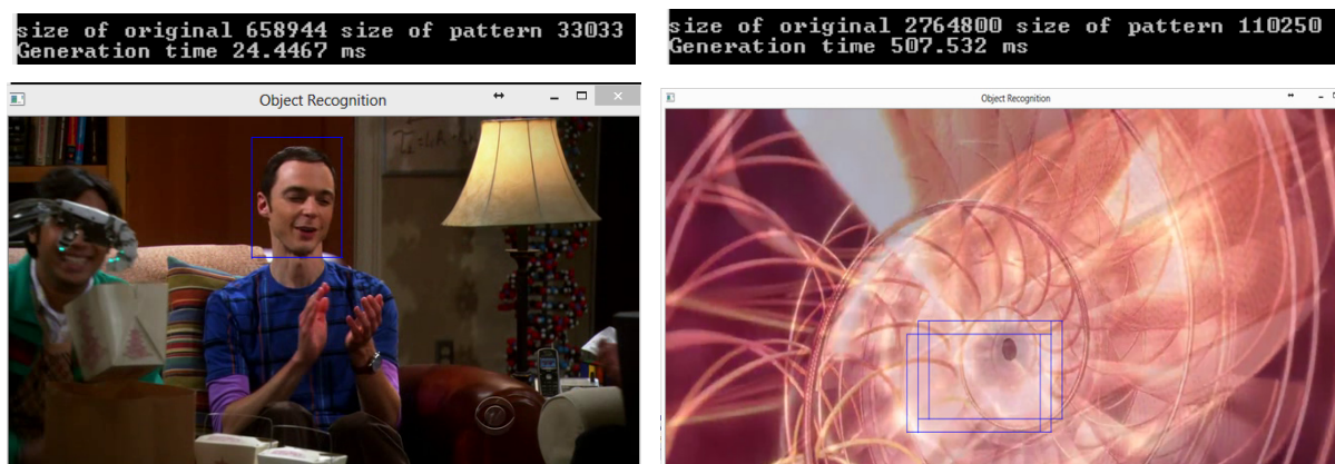
Рис. 2. Результат поиска (шаг шаблона = 20 пикселей и порог точности = 70 %)
