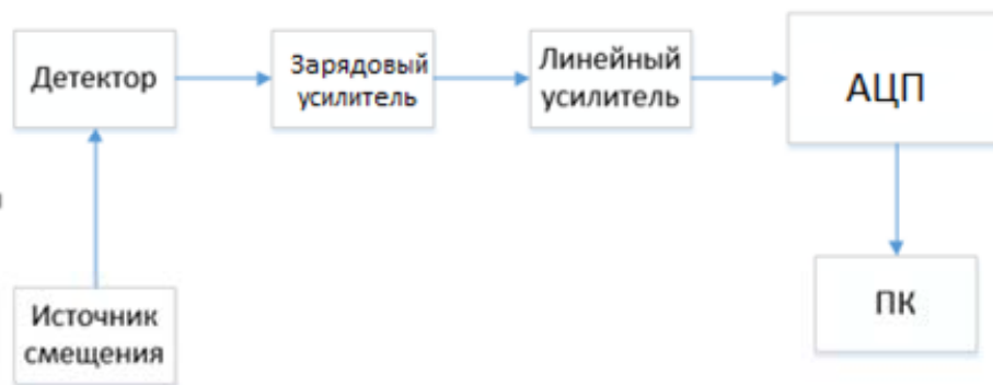
Рисунок 1- Блок схема спектрометра
