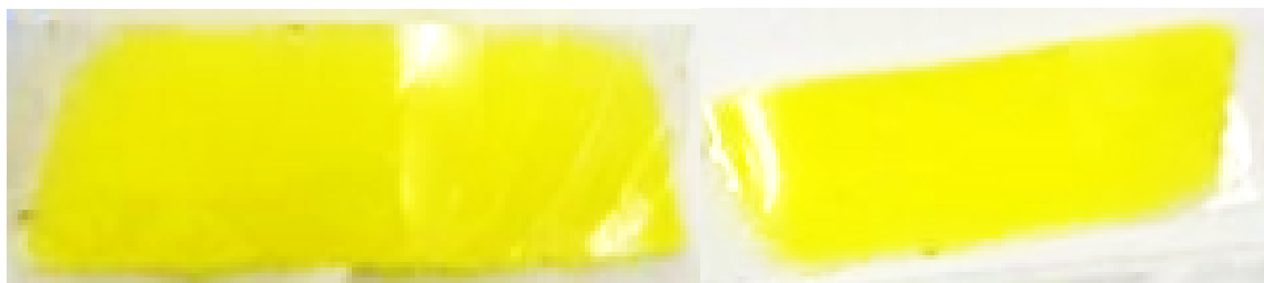
Рисунок 3.1 – Образец композитного люминофора толщиной 1,1 мм
